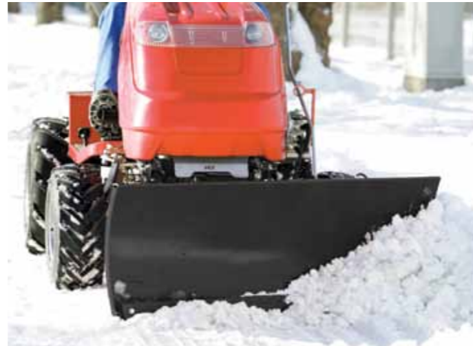
Lama da neve anteriore da 110 cm o spazzolone con trasmissione idraulica
